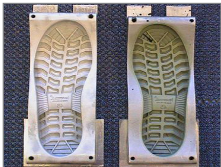
Støbeforme til skosål efter ca. 15 min. i ultralydsrensekar.
